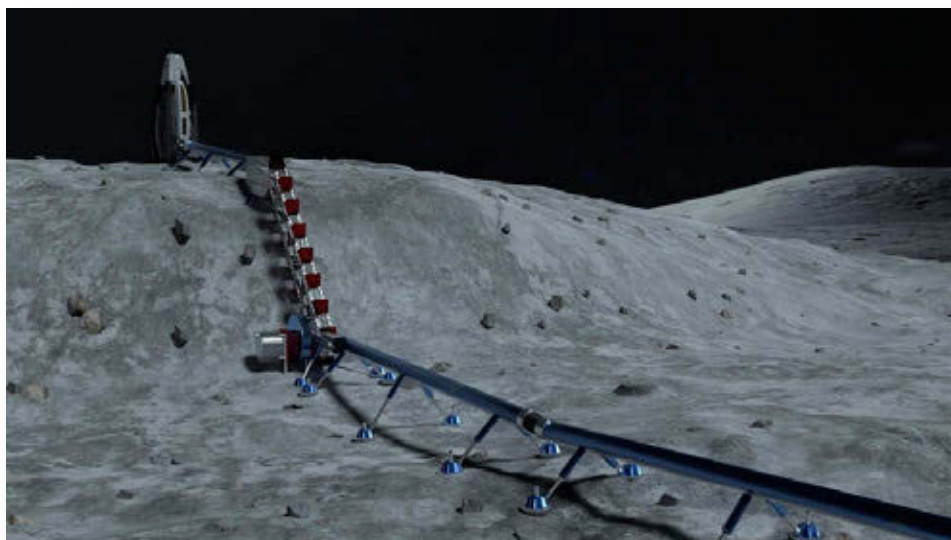
Rozwiązanie automatyzacji transportu regolitu, proponowane przez SPACETEAM na konkurs Over the Dusty Moon
